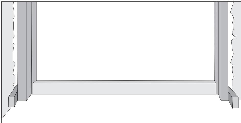
После забивания клиньев, ставится распорка, четко напротив нижних клиньев. Размер распорки равен длине двери плюс 6 мм на зазоры. Таким образом, распорка должна составлять, к примеру, ширину дверного полотна равная 800 мм то ширина распорки должна составлять 806 мм.
