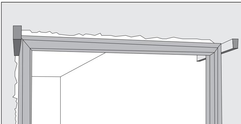
Фиксация нижних клиньев происходит немного другим образом. Предварительно следует проверить уровнем правильность положения по вертикали и по горизонтали.
